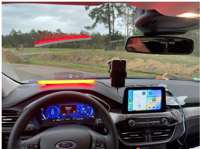
Figuur 5 Impressie van de plaats van de schermen van de smartphone, de auto-display en de geactiveerde LED-strip
